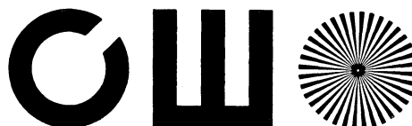
Fig. 108 Några optotyper: Landolts ring, Snellens hake, Siemens' stjärna
