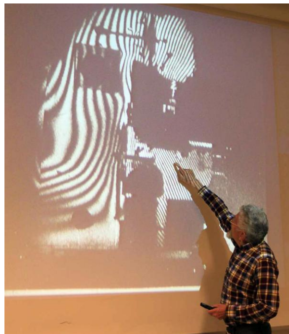
Nils Abramson räknar interferensfransar på ett fräsmaskinstativ från ett foto av ett Sandwich- hologram
